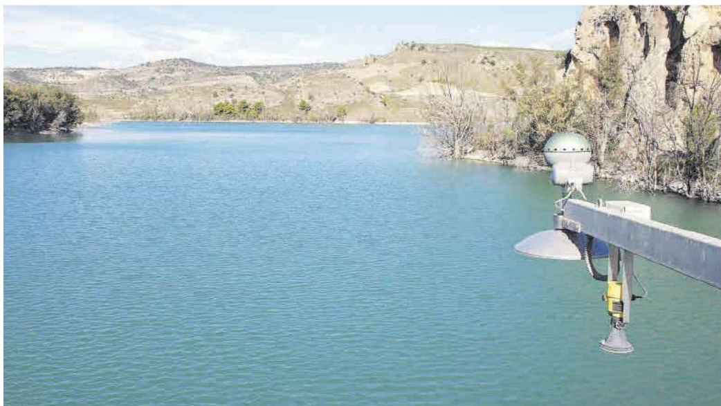
Los sensores de la red de vigilancia SAIH monitorizan tanto variables meteorológicas como el nivel de caudales en cauces y embalses.
